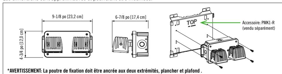
\*AVERTISSEMENT: La poutre de fixation doit être ancrée aux deux extrémités, plancher et plafond.
