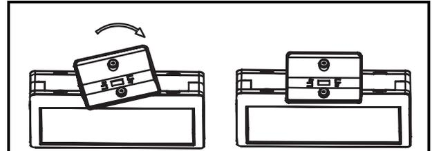
Insérez le pavillon de recouvrement dans le boîtier à un angle de 20 degrés et tournez. Le pavillon est maintenant fermement verrouillé.
