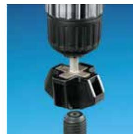
Durant l'installation, la mèche de foret de montage à goujon faite sur mesure s'éjecte elle-même de l'embase de montage assurant un couple approprié et empêchant le craquement ou la cassure du montage du fait d'un serrage excessif.
