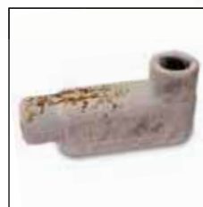
Exposé durant 500 heures à une brume saline de 5 %, ce corps de conduit en fonte standard galvanisée illustre l'adhérence d'une couche de sel et un montant significatif de rouille.
